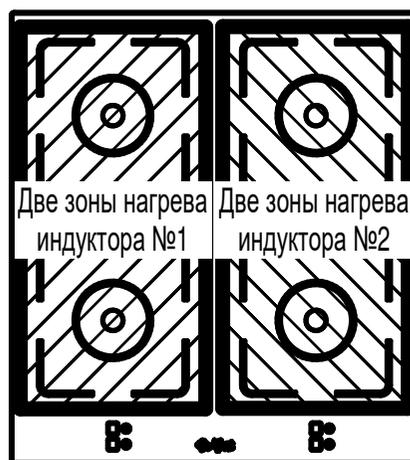
Плита индукционная кухонная настольная КИП-47Н предназначена для приготовления первых, вторых и третьих блюд в специальной наплитной посуде. Посуда должна быть с плоским дном, обладающая магнитными свойствами: посуда из нержавеющей стали или алюминия с ферромагнитным дном, чугунная посуда (посуда, к которой притягивается магнит).
